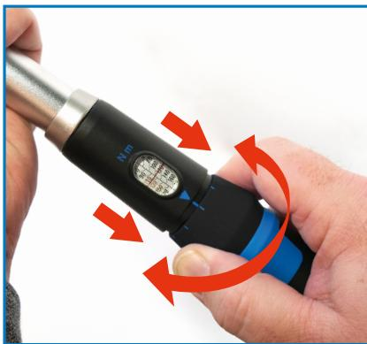
Halten Sie den Einstellring in dieser Position und drehen Sie ihn bis der gewünschte Drehmomentwert auf der Skala angezeigt wird.
