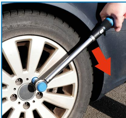
Drücken Sie den Drehmomentschlüssel in der Mitte des Handgriffs in Uhrzeigersinn und stoppen Sie direkt nach einem „click“ Geräusch.
