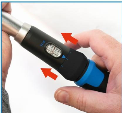
Stellen Sie sicher, dass der gewünschte Drehmomentwert richtig eingestellt ist. Dann lassen Sie den Einstellring los. Damit ist der Drehmomentschlüssel gegen ungewollte Veränderung des eingestellten Wertes gesichert.
